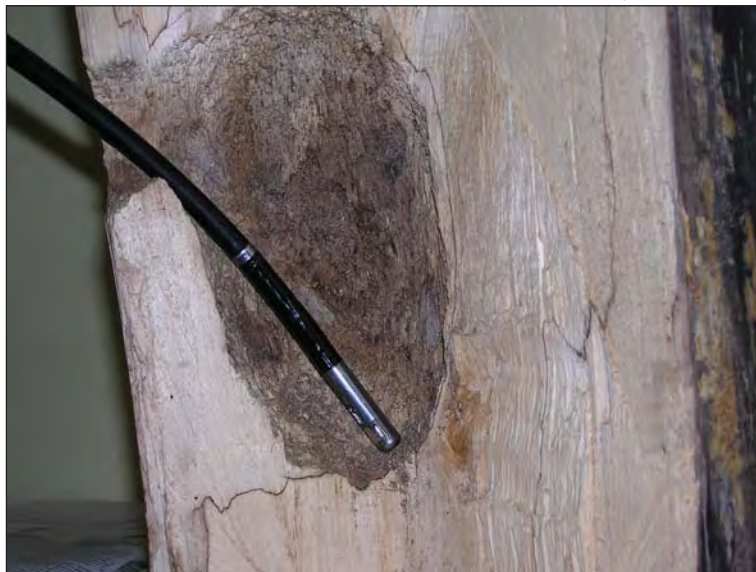
Фото 3. Використання ендоскопа при обстеженні дупла.
