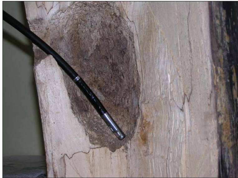
Фото 3. Використання ендоскопа при обстеженні дупла.
